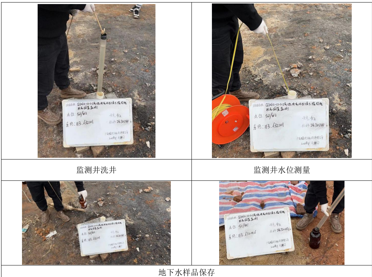
图 4.2-4 地下水样样品采集现场照片
