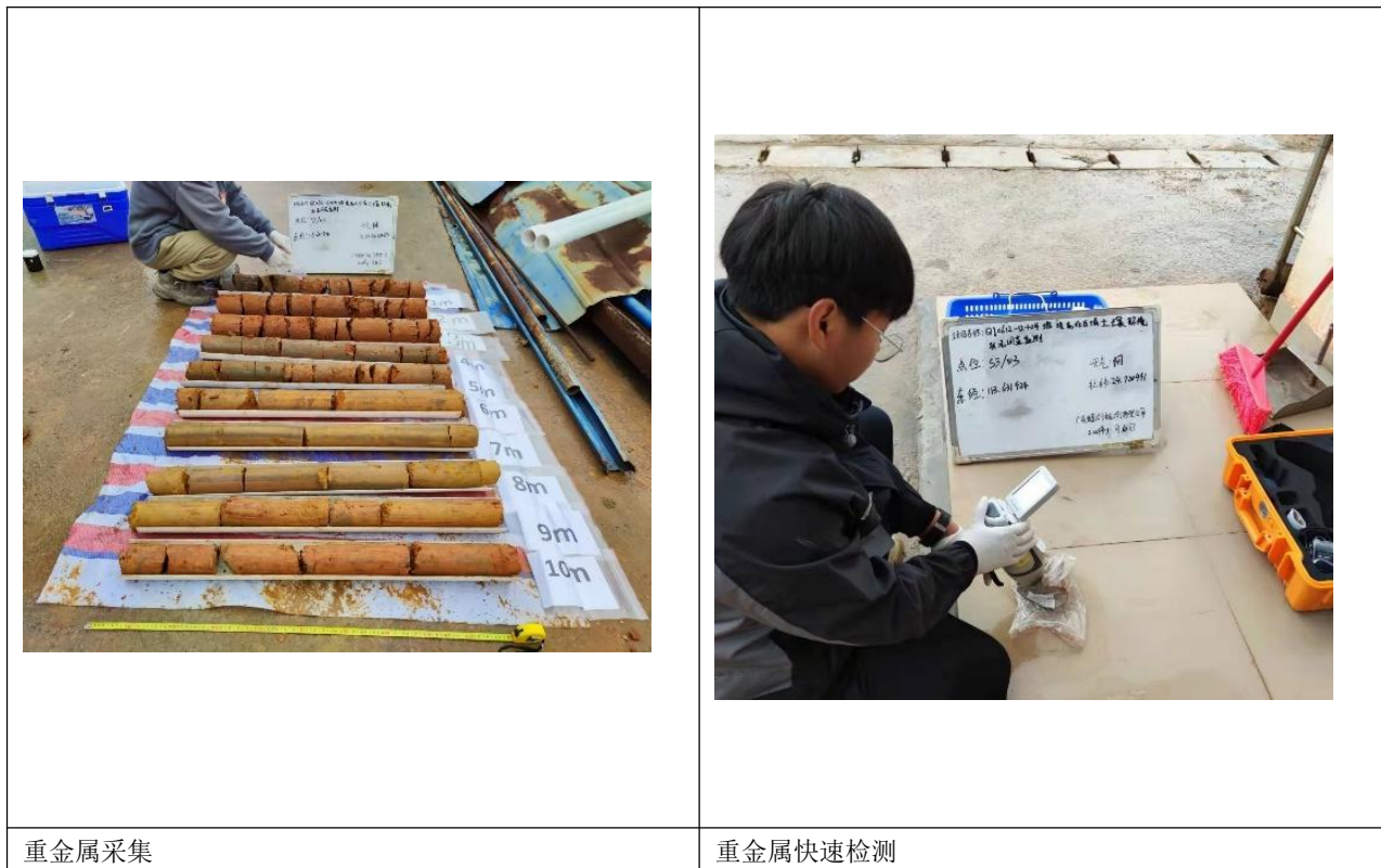
图 4.2-2 地块现场土壤样品采集照片
